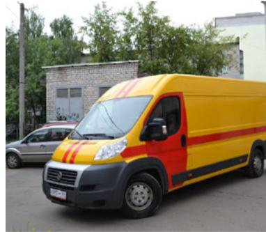
«Тверь Водоканал» пополнил парк спецтехники небольшими канало-промывочными машинами. На фургон Fiat установлено современное немецкое оборудование Rothenberg. Мощный насос способен создать давление до 200 атмосфер. В машине
